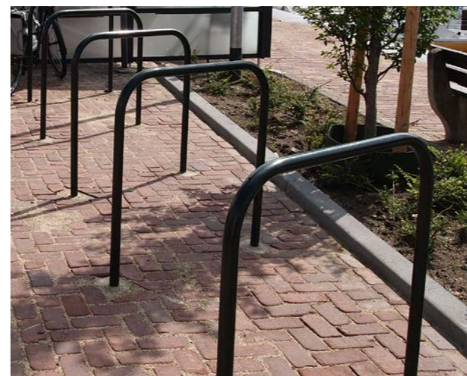
Fietsnietjes Exact type fietsen rekken nader te bepalen door stadsraad. Bijvoorbeeld: type Primo 600, kleur: RAL 6009, standgroen leverancier Groundlevel
