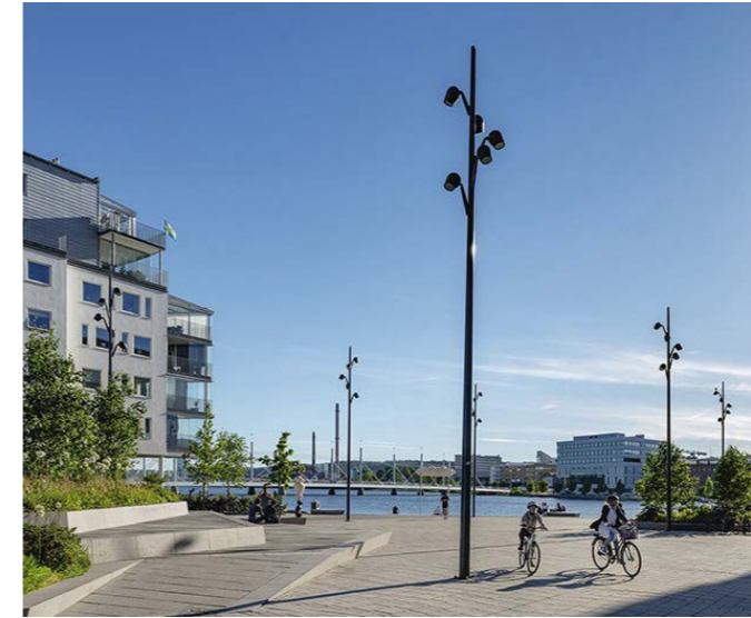
Hoge lichtmast met spots Lichtmast van staal, conische vorm, hoogte 10,00 meter RAL kleur RAL 7016 met 3 ronde spots, type Selux Olivio
